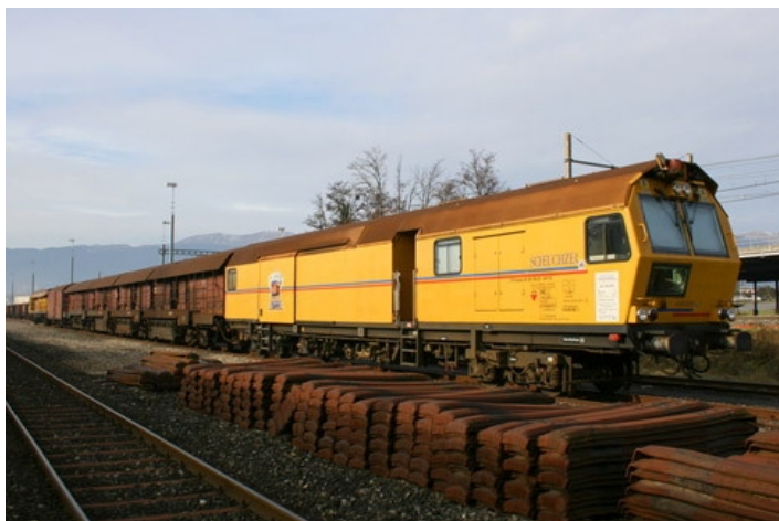
Train meuleur de rails (Scheuchzer S.A.)
